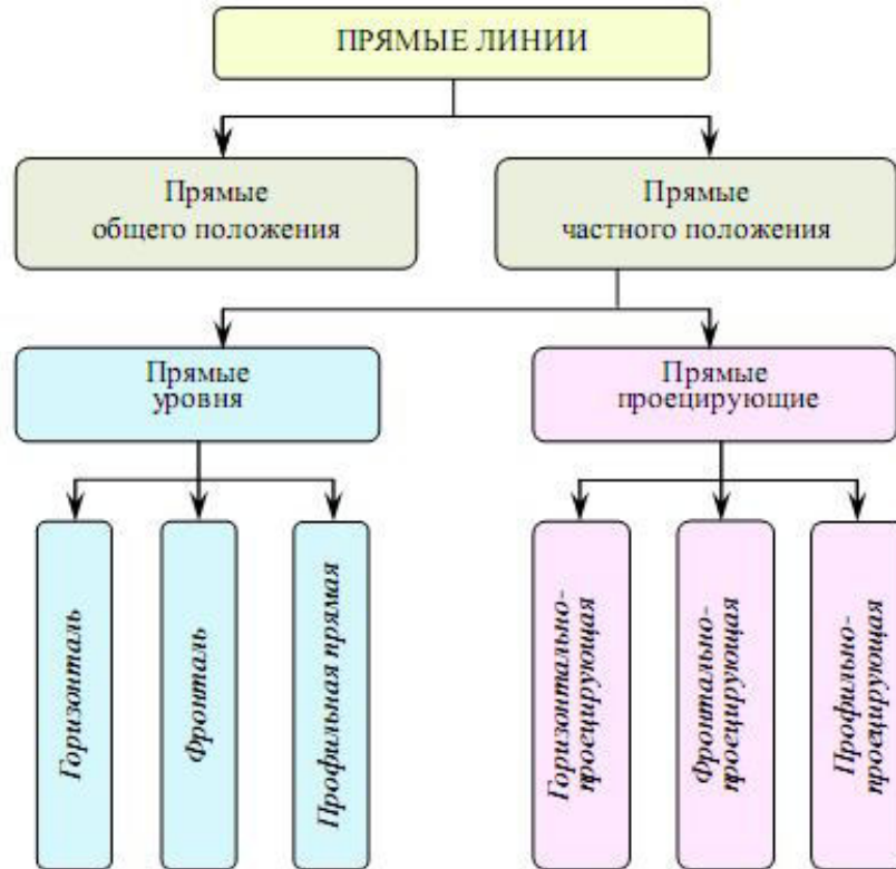
Рисунок 1.4 – Классификация прямых по положению относительно плоскостей проекций
