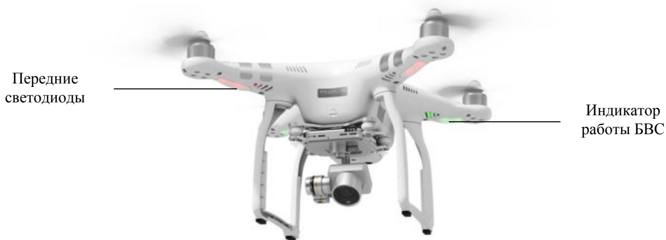
Рис. 8.1. Светодиоды и индикаторы работы БВС
