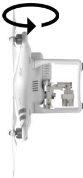
Рис. 9.2. Вращение БВС в вертикальном положении
